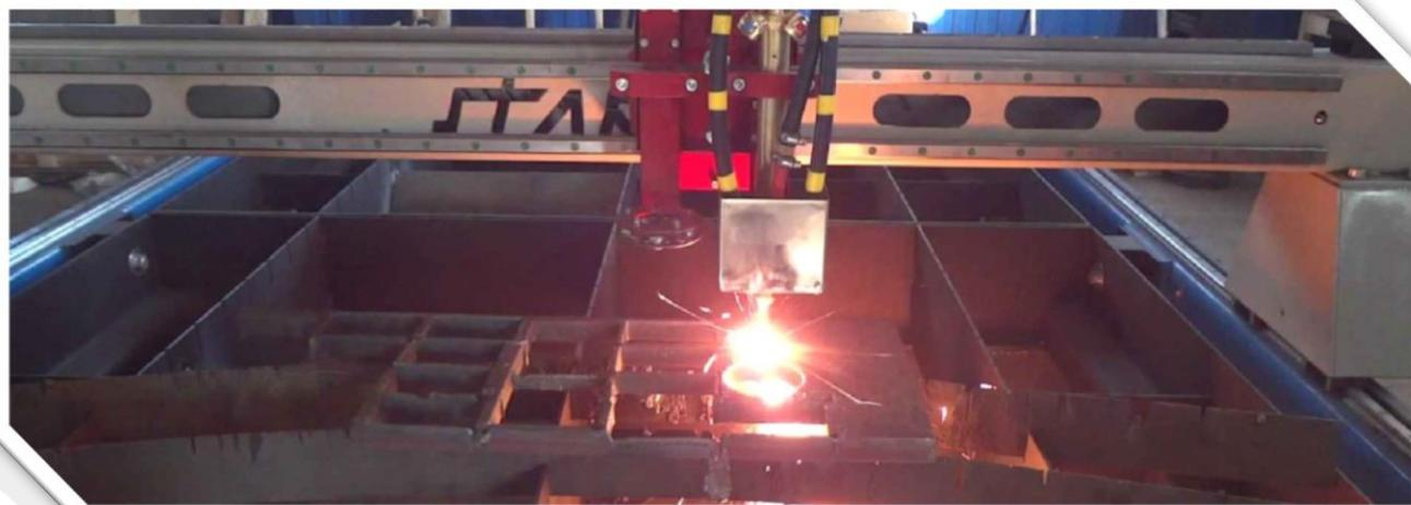
**Станок плазменной резки металла.**
